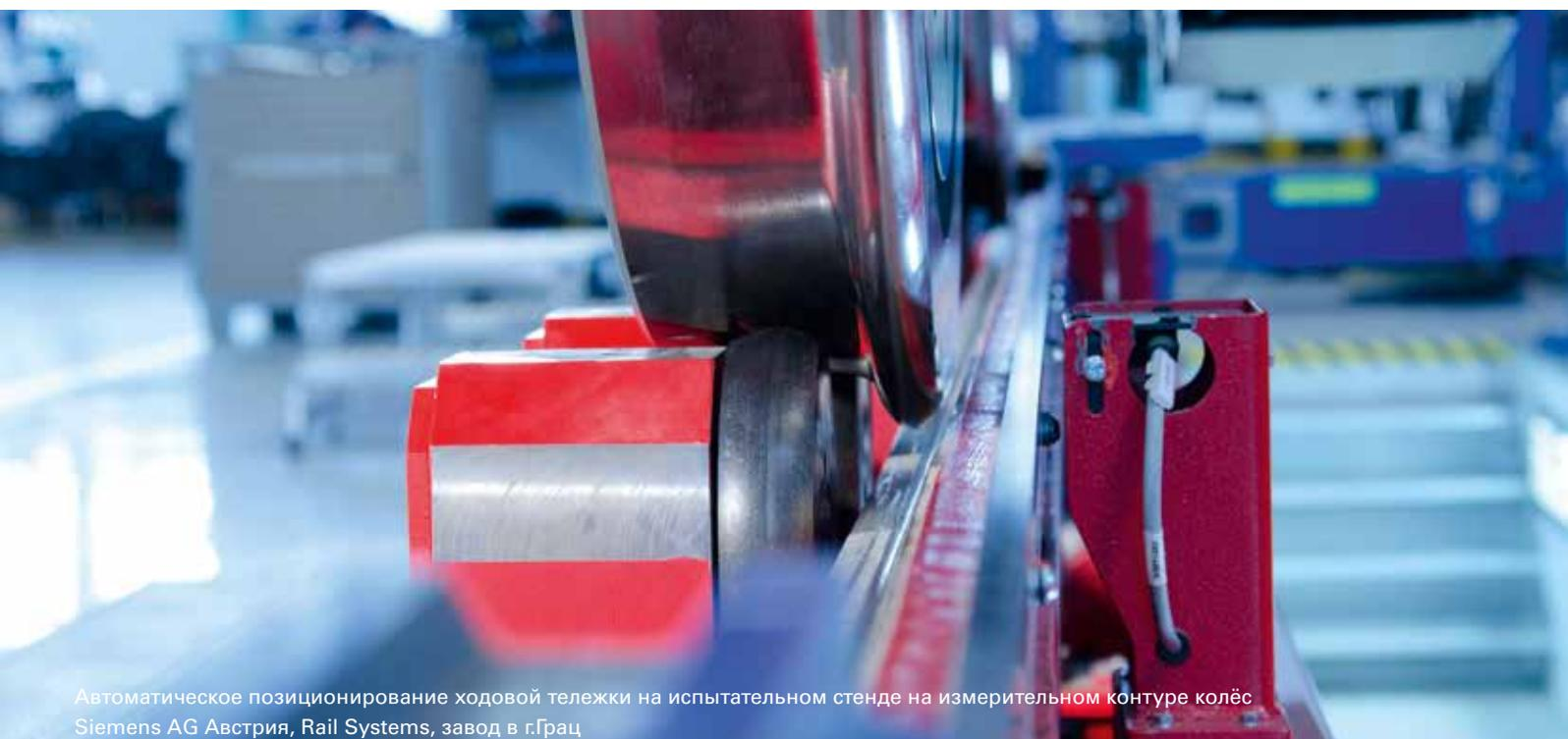
Автоматическое позиционирование ходовой тележки на испытательном стенде на измерительном контуре колёс
