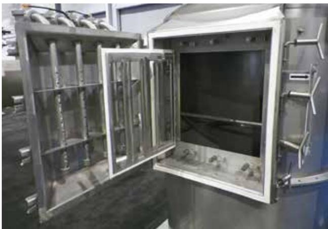
**Cleanable Side Entry Receiver (CSER), pneumatischer Filterabscheider**
