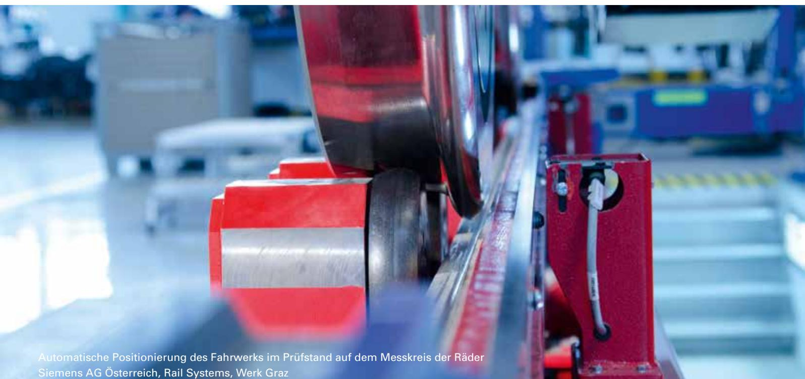
Automatische Positionierung des Fahrwerks im Prüfstand auf dem Messkreis der Räder
