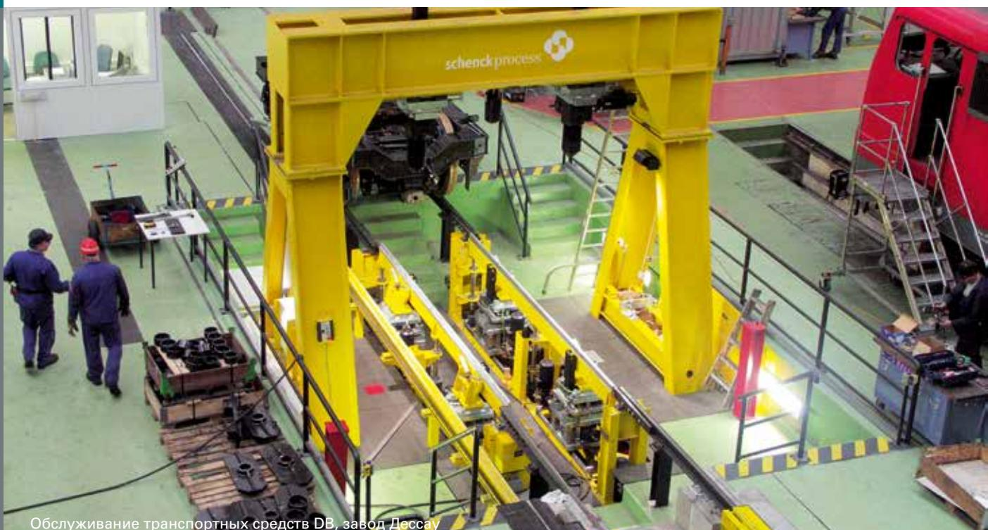
Важным критерием при установке испытательного стенда является гибкий план, оптимально подходящий к обстановке цеха и требованиям производства. Продукция компании Schenck Process MULTIRAIL® BogieLoad pro и MULTIRAIL® BogieLoad plus уже благодаря своим закрытым рамам сводит испытательные усилия, принимаемые фундаментом, к минимуму. При вертикальном расположении стендов относительно нулевого уровня рельсового пути цеха имеется три варианта установки.
