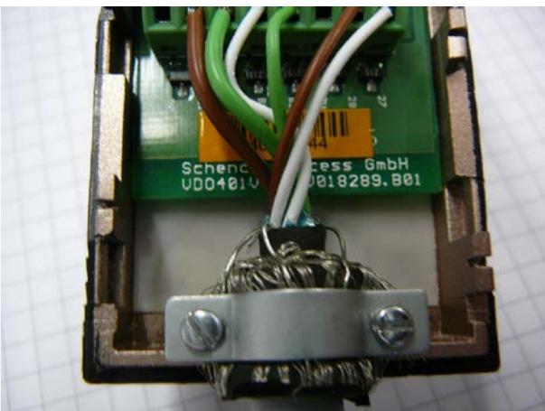
Abb. 50: Verbindung Innen- und Außenschirm
