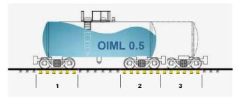
Bild 02: Installations-Layout für MULTIRAIL® LiquidWeight für Wäge-Genauigkeitsklasse 0,5 für Waggoneinzelgewichte gemäß Eichordnung und OIML-R 106
