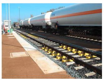
Bild 01: neue dynamische Gleiswaage A 124 - MULTIRAIL® LiquidWeight
