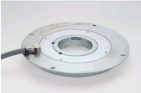
Die Radialkraftaufnehmer werden direkt zwischen den Tragblechen der Traverse und der zentralen Achse, auf der die Seilscheiben gelagert sind, eingeschraubt.
