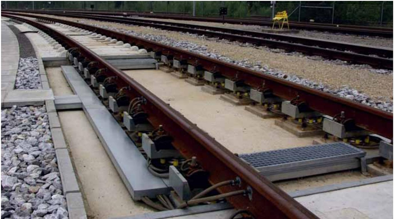
**Bild 20: Messverfahren für Q-Messung**
