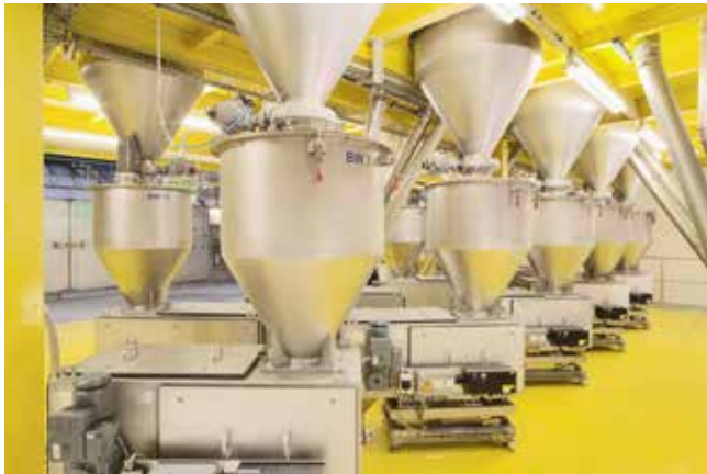
Bild 2: Die hygienisch ausgeführten Dosierbandwaagen MULTIDOS® L werden beispielsweise bei der Produktion von Paniermehl eingesetzt.
