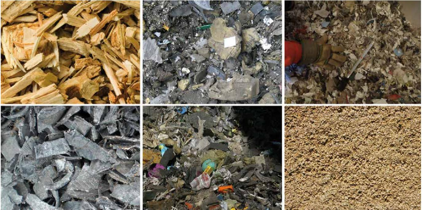
**Bild 1: Beispiele unterschiedlicher Brennstoffe: Holzhackschnitzel, Produktionsabfälle, Schredderleichtfraktion, Reifenschnitzel, Recyclingabfälle, Abfallstäube**
