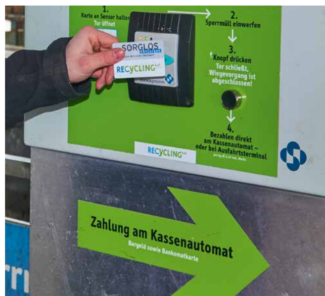
Bild 4: Der kostenpflichtige Abfall wird an der Containerwaage entladen, automatisch gewogen und die Gebühren auf der Einzel- oder Dauerkarte berechnet.
