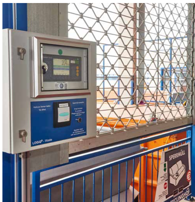
Bild 5: An den Entsorgungsstationen wird der Abfall in 1-kg-Schritten gewogen.
