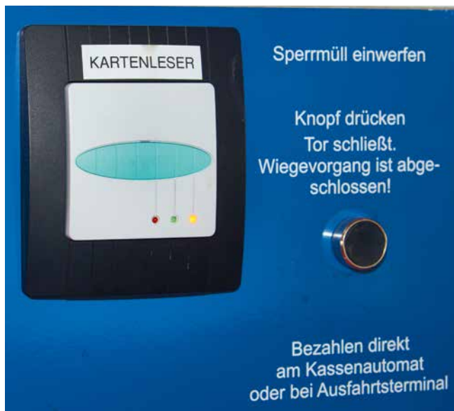
Bild 6: Die abgegebene Menge wird auf der ID-Karte gespeichert und vor der Ausfahrt am Bezahl- oder Ausfahrtsterminal (nur Bankkarte oder Kreditkarte) verrechnet.
