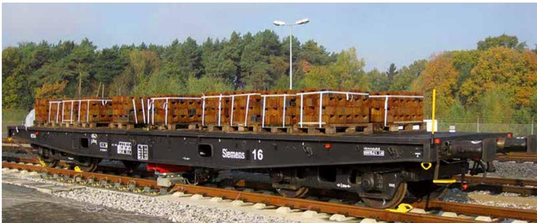
**Abb. 8: Beladener Flachwagen von Typ Smp mit Kalibriereinrichtung**
